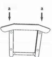
4-5. Verrouiller les deux pattes latérales au bâti vertical en serrant bien. Appliquer de la pression en tournant la vis dans le trou percé. La vis et les trous percés ont été conçus pour un ajustement très serré dans le but d'assurer la stabilité de l'ensemble.
